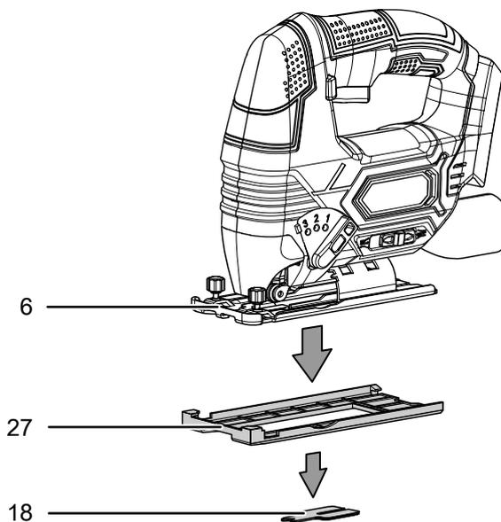
4. Pour remettre en place la protection anti-éclatement (18), pressez celle-ci prudemment de bas en haut dans l'encoche de la plaque de base (6) jusqu'à ce qu'elle s'enclique. Veillez à ce que la face lisse de la protection anti-éclatement (18) soit orientée vers l'extérieur de l'appareil.
