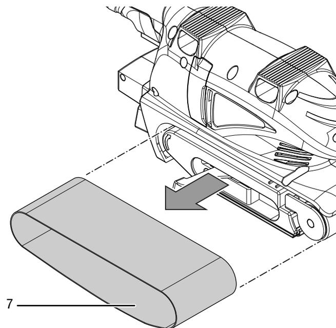
3. Posizionare il nuovo nastro abrasivo (7). Fare attenzione che la direzione delle frecce sul lato interno del nastro abrasivo (13) e sul dispositivo (14) corrispondano.
