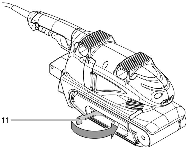
5. Accendere il dispositivo. Lo scorrimento del nastro viene centrato automaticamente al momento dell'accensione. Se lo scorrimento del nastro non viene centrato al momento dell'accensione, è necessario eventualmente impostare lo scorrimento del nastro manualmente con la vite di regolazione (10).
