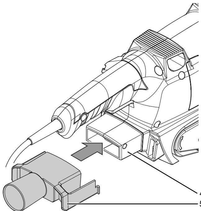
2. Collegare un aspirapolvere adeguato (per es. un aspirapolvere industriale) all'adattatore per l'aspirazione della polvere (5). In caso di necessità è possibile collegare prima il riduttore (8) per l'aspirazione della polvere all'adattatore per l'aspirazione della polvere (5). In caso di dubbi, contattare il produttore del proprio aspirapolvere.
