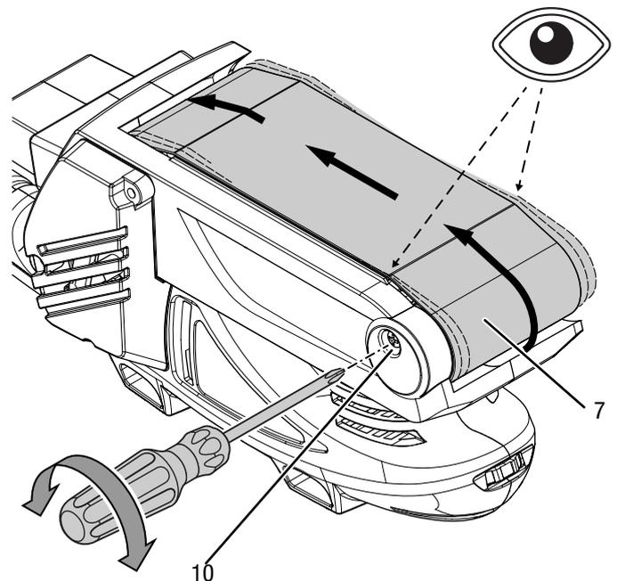
⇒ Se lo scorrimento del nastro non è centrato dopo l'impostazione, è necessario sostituire il nastro abrasivo (7).
