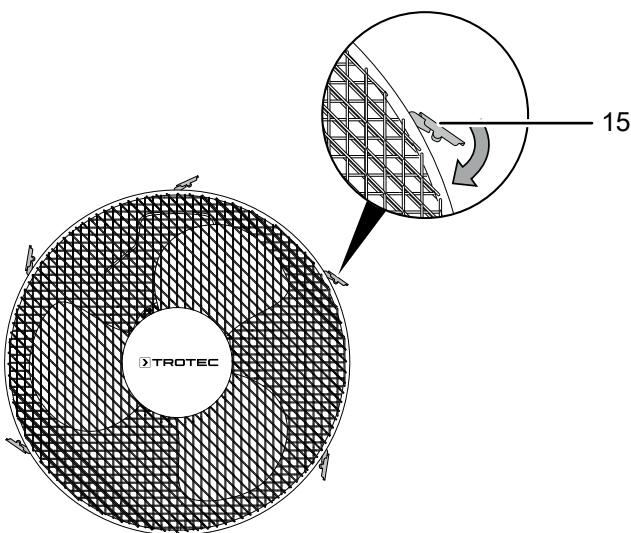
3. С помощью расположенного внизу крепежного винта (16) скрутите обе защитные решетки.
