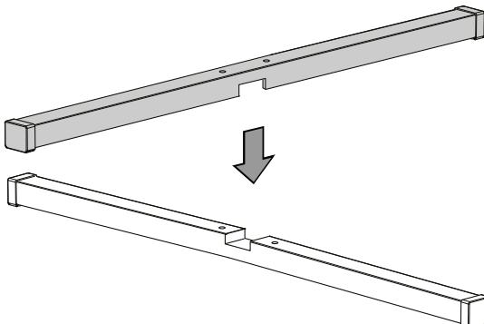
2. Установите стойку по центру на оба соединенных элемента ножки.
