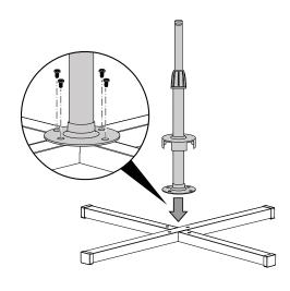
4. Deslizar a capa de cobertura (7) do apoio sobre os parafusos.
