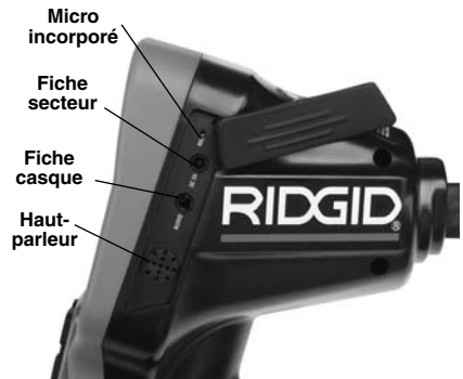
Figure 3 – Branchements côté droit
