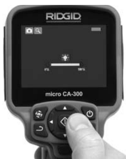
Figura 15 – La luminosidad de los DELs siendo regulada
