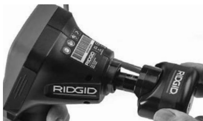
Figur 18 – Kameraets tilkoplingsplugg installert
