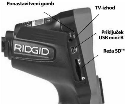
Slika 4 – Pokrov priključkov na levi strani
