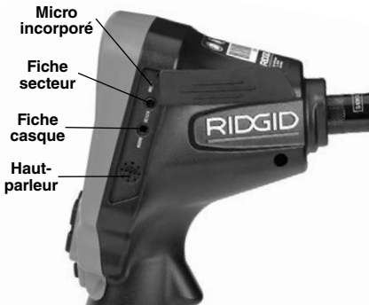
Figure 3 – Branchements côté droit
