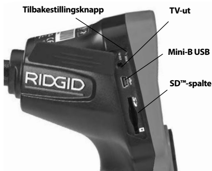
Figur 4 – Portdeksel på venstre side
