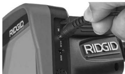
Рис. 6 - Питание прибора от адаптера переменного тока
