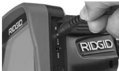
Figura 6 – Ligar a Unidade com Adaptador de CA
