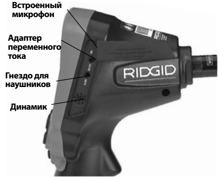
Рис. 3 - Крышка гнезд с правой стороны прибора
