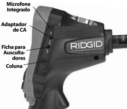
Figura 3 - Tampa da Porta Lateral Direita
