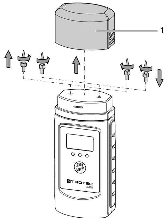
3. Avvitare sul dispositivo i nuovi puntali di misurazione.
