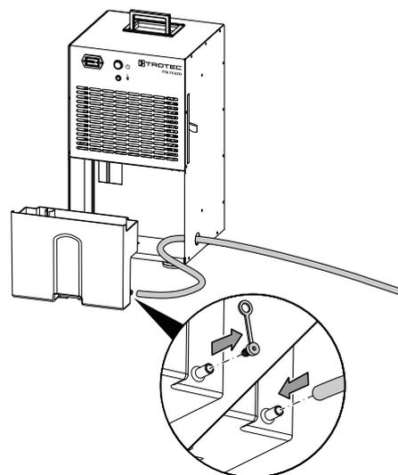
3. Passez le tuyau à travers le trou dans la tôle latérale de l'appareil.
