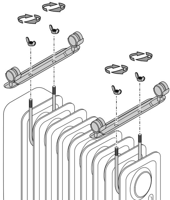
6. Serrare le piastre di montaggio, i dadi ad alette e i bulloni a U. Fare attenzione che le piastre di montaggio siano fisse. Devono poggiare uniformemente sulle colonne in modo da poter garantire una posizione eretta e simmetrica del dispositivo.
