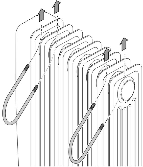
5. Appoggiare le piastre di montaggio con le ruote sui bulloni a U. Osservare le scanalature presenti su un lato delle piastre di montaggio. Queste devono essere rivolte verso la parte anteriore del dispositivo (quadro di controllo).
