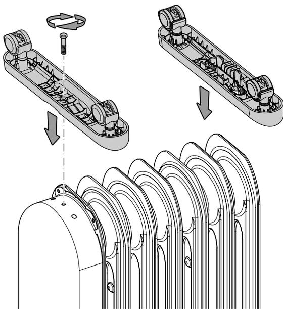
⇒ Fare attenzione che i piedini d'appoggio e le ruote siano fissate bene. I piedini d'appoggio devono poggiare uniformemente sulle colonne in modo da poter garantire una posizione eretta e simmetrica del dispositivo.
