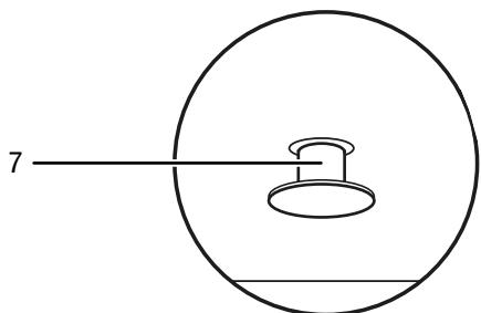
Uredaj se može rabiti tek kada se sklopka za zaštitu od prevrtanja (7) potpuno gurne u uređaj. To se događa automatski kada uređaj postavite na prikladnu podlogu.
