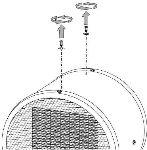
2. Montez la poignée de transport au moyen des vis et des rondelles.
