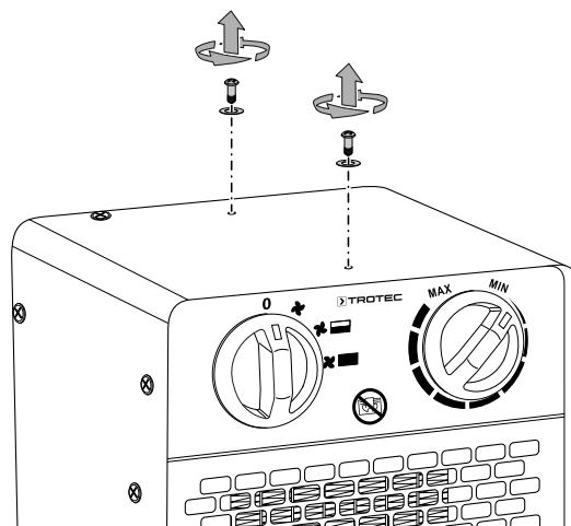
2. Montați mânerul de transport cu șuruburile și șaibele.
