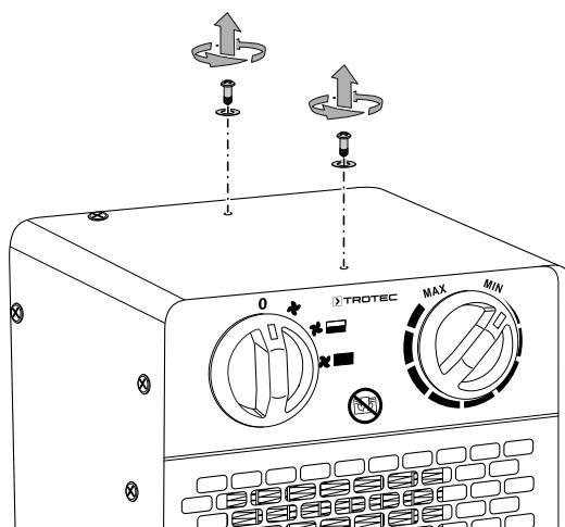
2. Monter transporthåndtaket med skruene og underlagsskivene.
